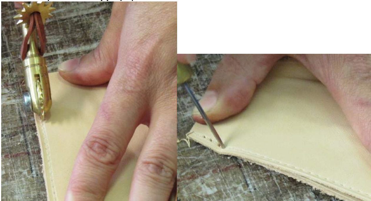
Obrázek 18: Vyznačení dírek a jejich propíchnání šídlem
