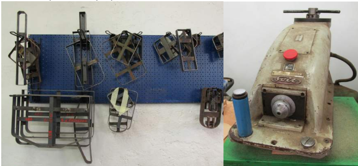
Obrázek 14: Vysekávací stroj a výsekové nože
