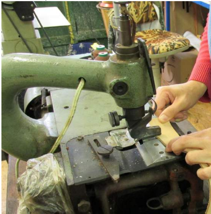
Obrázek 21: Vytěnění hran na šerfce
